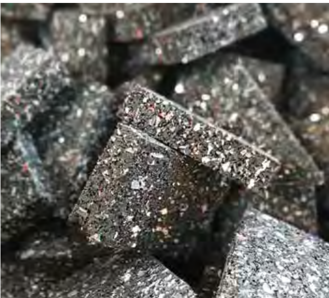
Isopads aus 95 % Altreifengranulat
