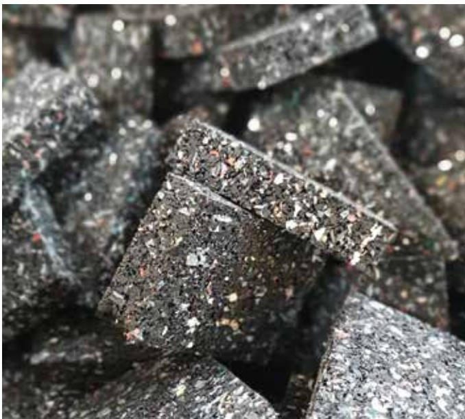
Isopads aus 95 % Altreifengranulat
